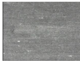
溝列工具（表面テクスチャの利用） 加工面の表面粗さ：0.04 \mu mRa
